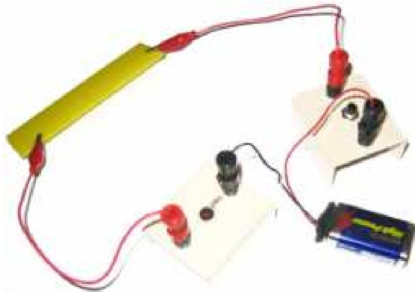
Place le 1er matériau entre les pinces crocodiles du circuit et appuie sur l'interrupteur.
