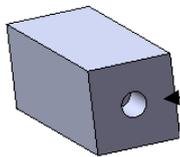
Au centre des diagonales, percer un trou de diamètre **6mm** et de **10 à 12 mm** de profondeur.
