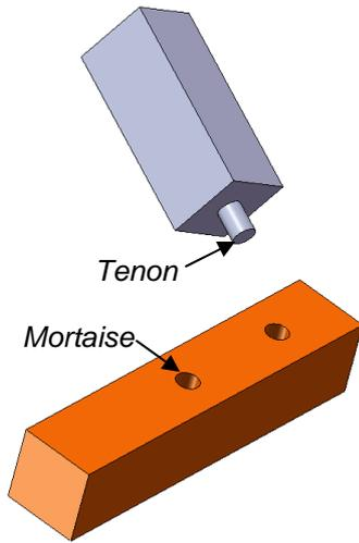
Le tenon mortaise est un assemblage utilisé par le menuisier et le charpentier.
