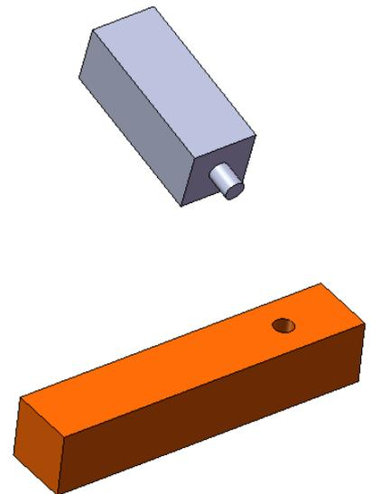
Au centre des diagonales, percer un trou de diamètre **6mm** et de **10 à 12 mm** de profondeur.
